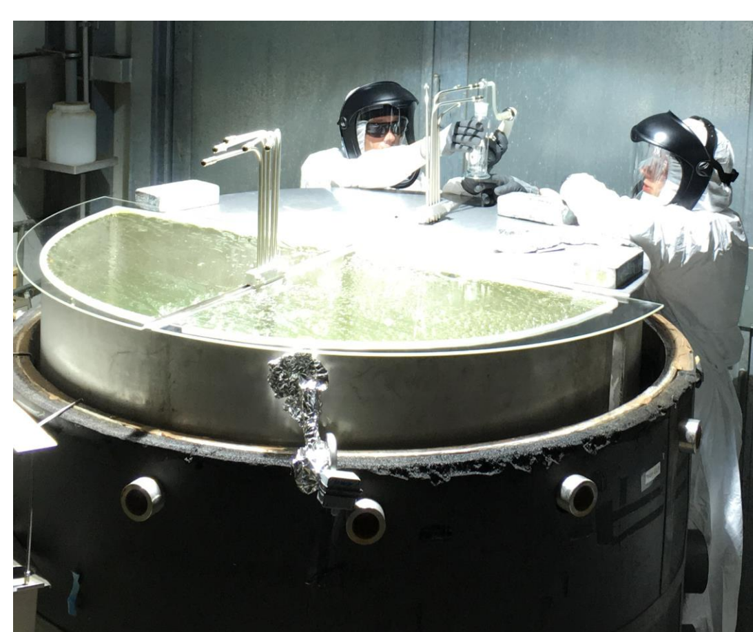
Probenahme unter besonderer Schutzausrüstung bei simuliertem Sonnenlicht (OSRAM HQI-TS (2000 W), light cut-off at 290 nm)
