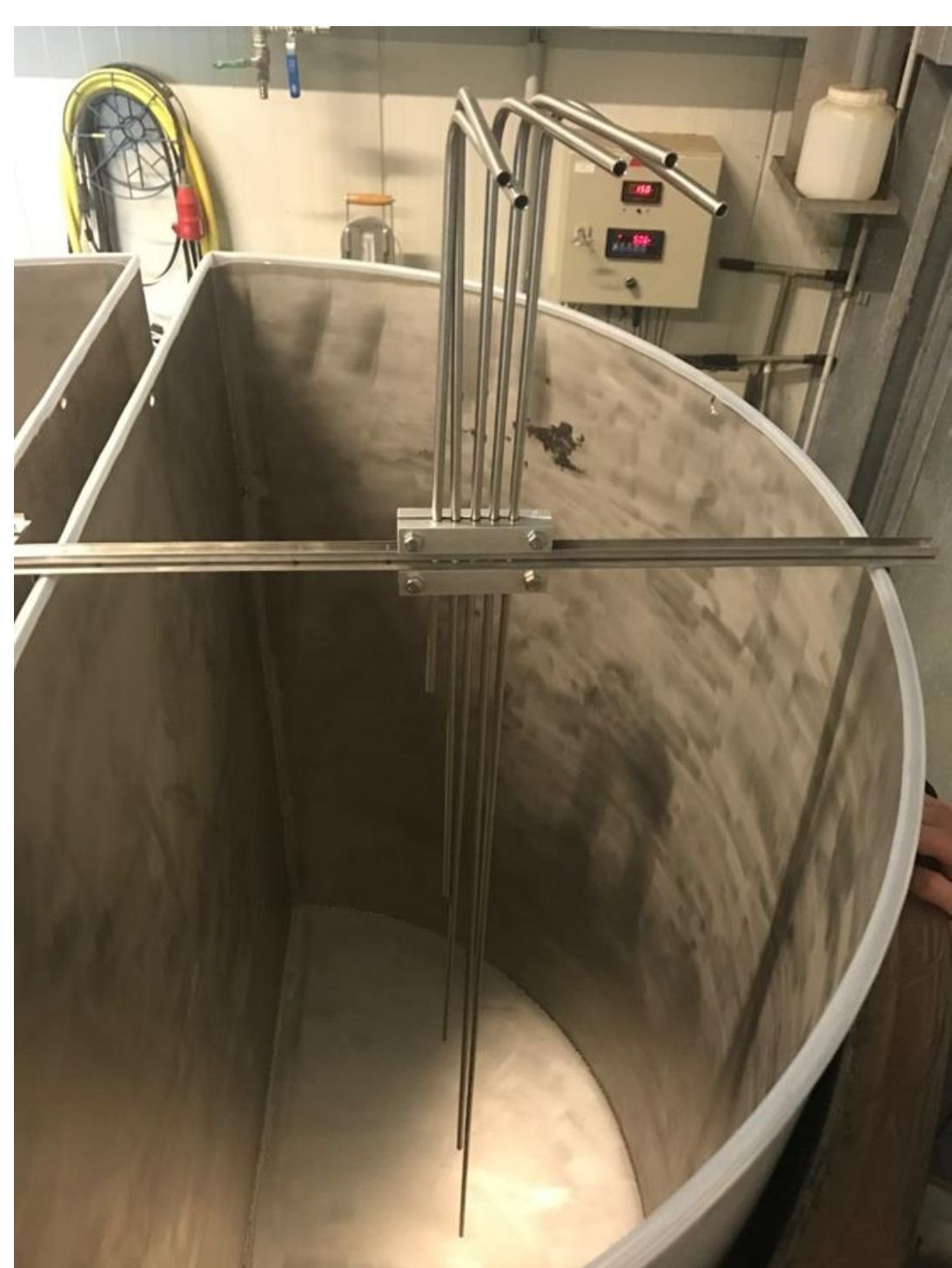
Probenahme in 5 Tiefen, ohne Durchmischung des Systems
